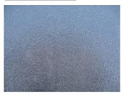
Результат: в зависимости от типа роликов (способа погрузки) пластик Anti Slip (средний) показал очень хорошую прочность на истирание при моделировании периода эксплуатации в 23 года.
