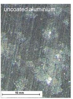
unbeschichtet (deutliche Korrosion)
