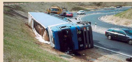
In der Linkskurve rutschte die Ladung nach außen. Dadurch stürzte der Sattelzug auf die rechte Fahrzeugsäule.
