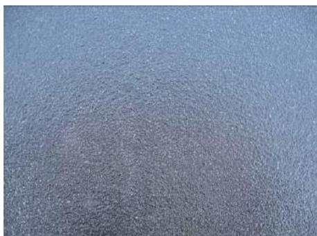
Результат: в зависимости от типа роликов (способа погрузки) пластик Anti Slip (средний) показал очень хорошую прочность на истирание при моделировании периода эксплуатации в 23 года.
